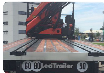
Rails pour grue
