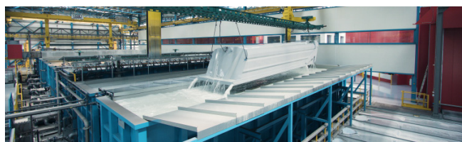
KTL: Proteção contra corrosão em chassi e caixa por cataforese
