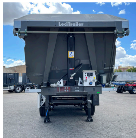
Frente inclinada com pala para toldo
